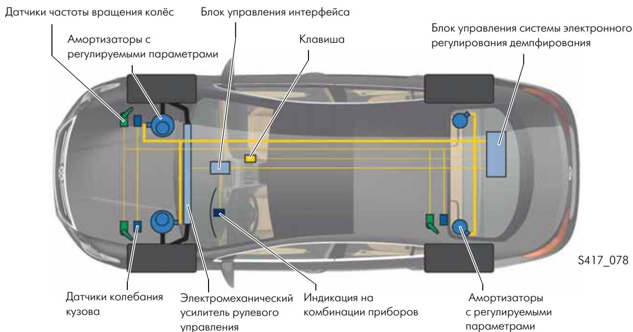
К компонентами адаптивной системы управления ходовой части DCC относятся четыре амортизатора с регулируемыми параметрами, блок управления интерфейса, обеспечивающий подключение к шинам данных CAN в Passat CC, блок управления системы электронного регулирования демпфирования, три датчика частоты вращения колёс и три датчика колебаний кузова.
