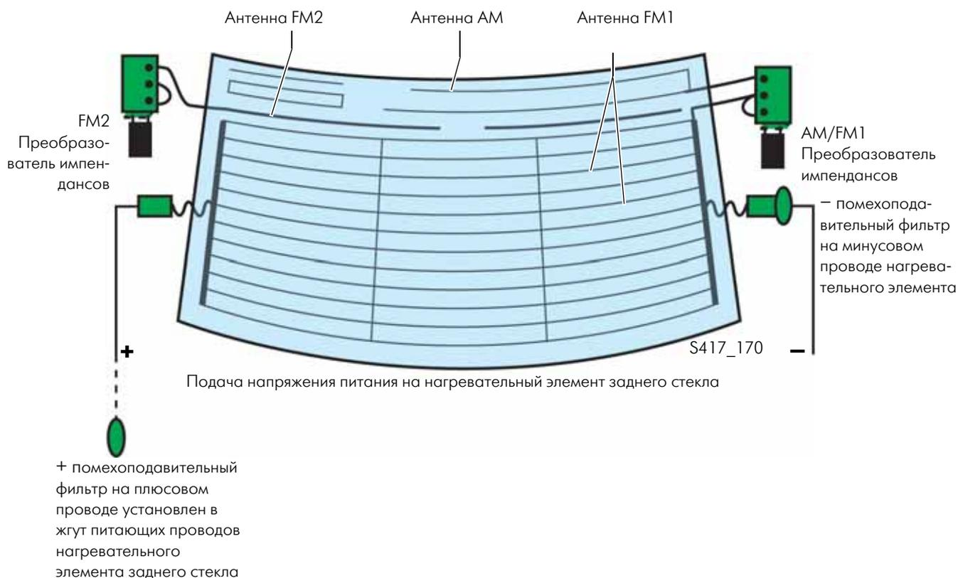
Фильтр помех для минусовой цепи подключён непосредственно к минусовому подключению нагревательного элемента заднего стекла (справа).
