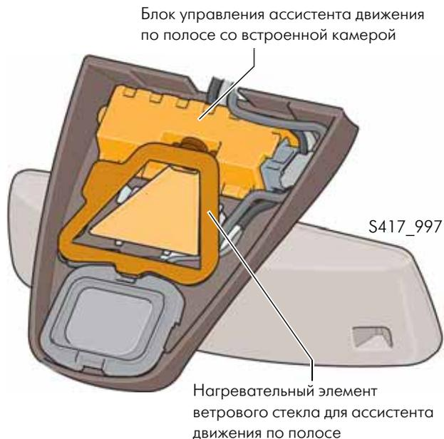
Главным компонентом ассистента движения по полосе является монохромная камера в блоке управления ассистента движения по полосе. Дополнительными узлами системы являются контрольная лампа ассистента движения по полосе и нагревательный элемент ветрового стекла для ассистента движения по полосе. Контрольная лампа обеспечивает индикацию режима работы ассистента движения по полосе.
