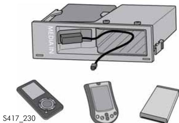
С помощью переходного кабеля Mini-USB можно подключить MP3-проигрыватель, телефон/коммуникатор и жёсткие диски MiniUSB.
