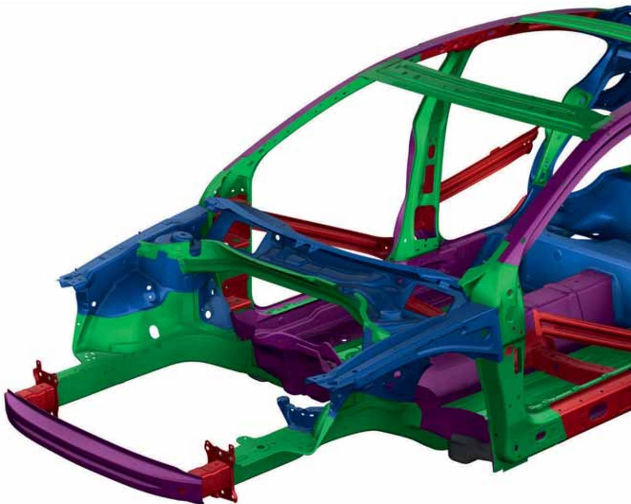
Кроме того, Passat CC — это ещё один пример тенденции использования высокопрочных и сверхпрочных стальных кузовных деталей, изготовленных методом термической формовки. Использование сверхпрочных стальных кузовных деталей, изготовленных методом термической формовки, позволяет уменьшить вес кузова без потери прочности.
