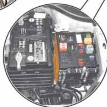
Дополнительный кронштейн реле, под блоком предохранителей и реле
