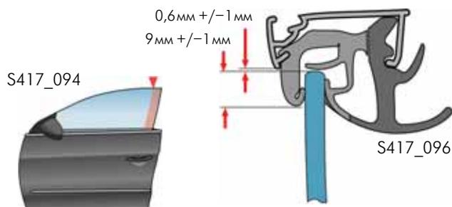
Регулировка высоты стекла передней двери необходима, если глубина опускания стекла в области стойки А и в области стойки В не соответствует заданным значениям, а кромка стекла не параллельна накладке стойки В.
