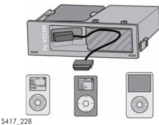
С помощью переходного кабеля iPod можно подключить различные устройства iPod. На устройстве индикации, которое должно поддерживать протокол управления и индикации (BAP), появляется индикация тех же списков воспроизведения аудиоданных, что и на iPod.
