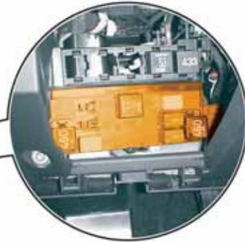
Кронштейн реле на блоке управления бортовой
