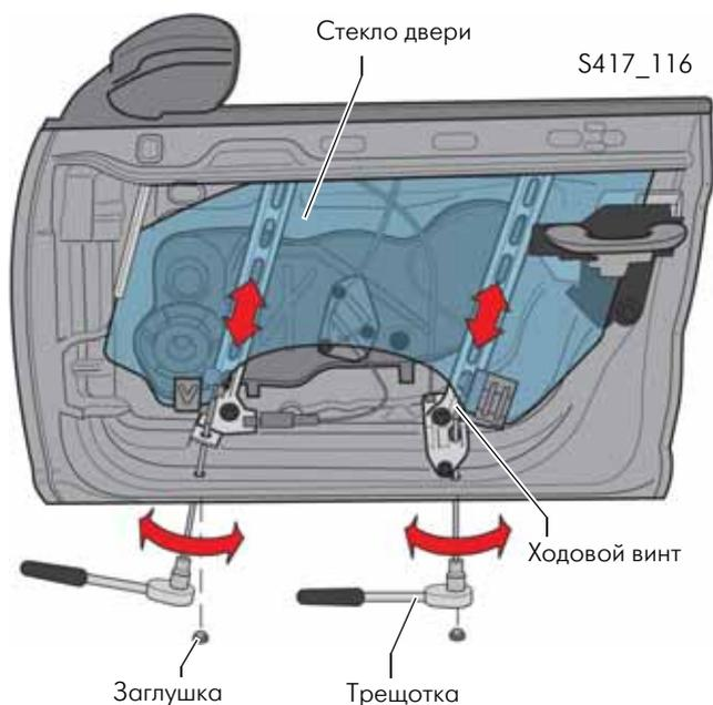
Перед выполнением регулировки высоты необходимо полностью опустить стекло двери и снять заглушки. Только таким образом можно вставить инструмент (трещотку) через левое и правое регулировочные отверстия в ходовые винты.
