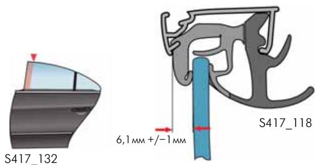
Если угол наклона стекла в области стойки В не соответствует заданному значению, необходимо выполнить регулировку стекла задней двери. Для задней двери также сначала выполняется регулировка угла наклона нижней, а затем верхней кромки стекла. Регулировка угла наклона стекла задней двери выполняется аналогично регулировке угла наклона стекла передней двери.
