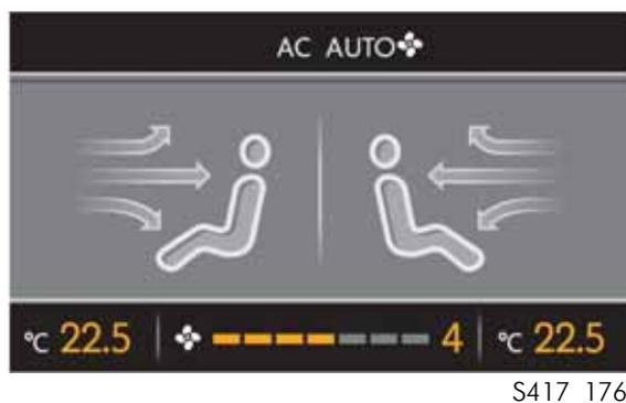
Кроме того, на дисплее магнитолы или радионавигационной системы появляется индикация данных климатической установки Climatronic. Так, например, при изменении выбранной температуры появляется всплывающая индикация температуры.
