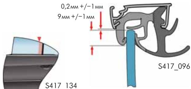
Регулировка высоты стекла задней двери необходима, если глубина опускания стекла в области стойки В и в области стойки С не соответствует заданным значениям, а кромка стекла не параллельна накладке стойки В. Регулировка высоты стекла задней двери выполняется аналогично регулировке высоты стекла передней двери.
