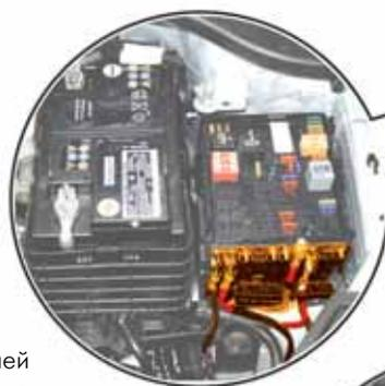
Блок входных предохранителей в левой части моторного отсека
