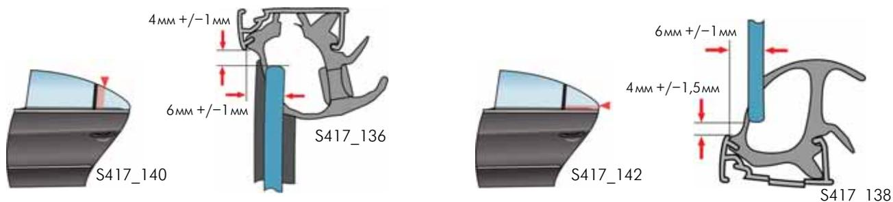
Если положение стойки заднего стекла не соответствует заданным значениям, необходимо выполнить регулировку его высоты и угла наклона.
