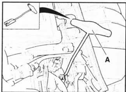
14.12 Разъединение разъема электропроводки свечи зажигания
