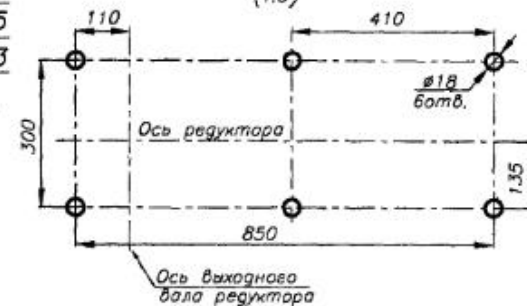
СХЕМА РАСПОЛОЖЕНИЯ БОЛТОВ КРЕПЛЕНИЯ ЭЛЕМЕНТОВ ПРИВОДА К РАМЕ (1:5)
