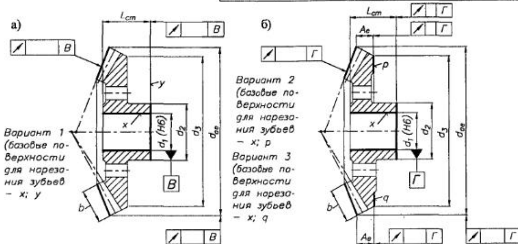
Рис. 11.3.23. Допуски формы и расположения поверхностей для вариантов 1, 2, 3 выполнения заготовок конического колеса при различных базовых поверхностях для нарезания зубьев
