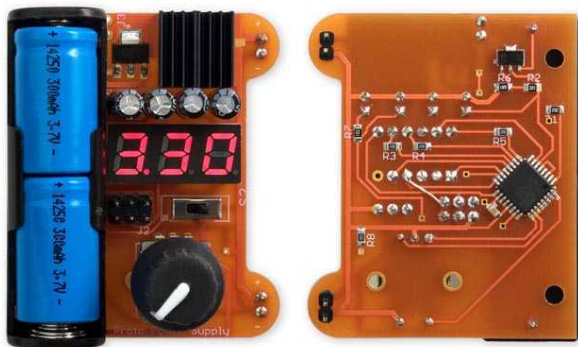
Рисунок 3. Верхняя и нижняя стороны готовой печатной платы источника питания Proto.
