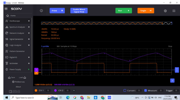
Рисунок 3б. Осциллограммы сигналов V_{RB} и V_{OUT} .
