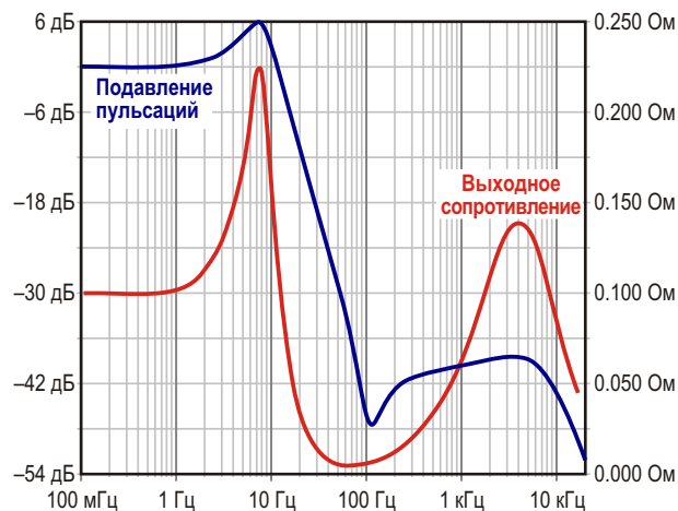
Рисунок 3. Выходное сопротивление и подавление пульсаций.
