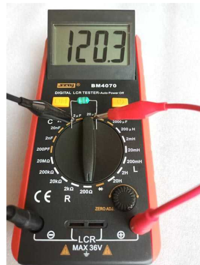
Рисунок 2. Сопротивление дросселя постоянному току ( R_S ).
