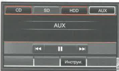
Илл. 26 Внешнее аудиоустройство, подключённое к разъёму AUX-IN.
