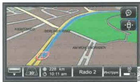
Илл. 90 Отображение карты в режиме 3D при ведении по маршруту (карта смещена).
