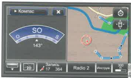
Илл. 76 Запись пути в режиме отображения карты с дополнительным окном компаса.
