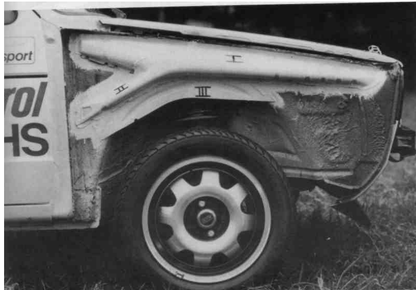
Так Y-образные листы укрепляют всю переднюю часть кузова, с которой они свариваются (I – Längsstrebe, II – Schenkel, III – Schließblech).
