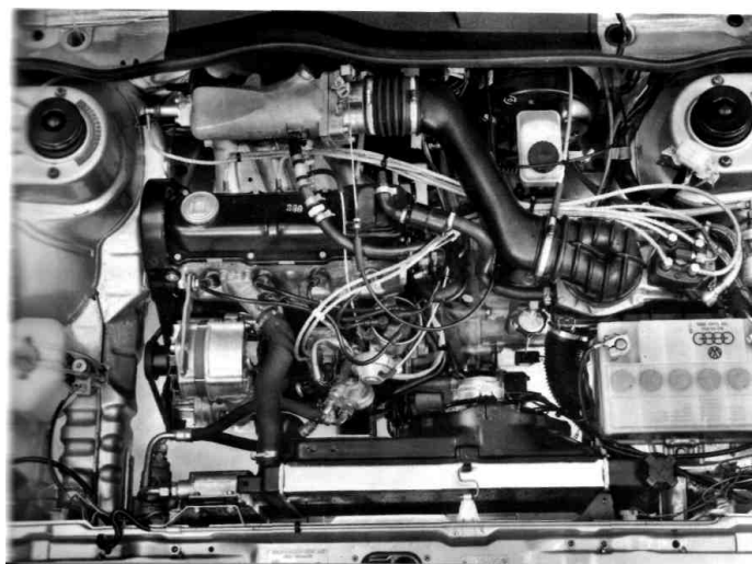
У мотора со впрыском моторный отсек Golf/Jetta/Scirocco хорошо заполнен. Слева, наряду с радиатором водяного охлаждения можно разглядеть серийный для этого мотора масляный радиатор.
