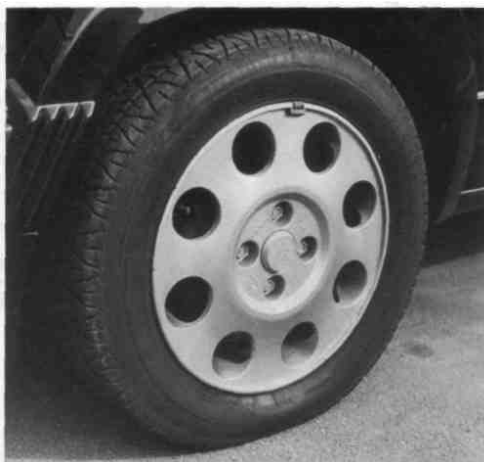
Шины Michelin TRX из-за их специальной конструкции применимы только вместе с изображенным ободом из легкого сплава.
