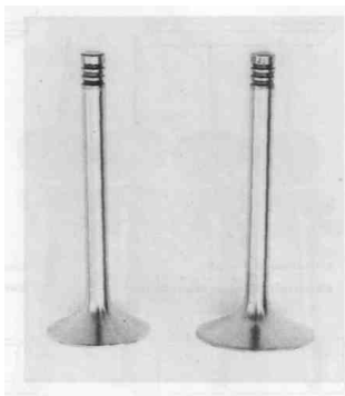
Обрабатывать тарелки клапанов до такой малой толщины нужно только у спортивных моторов.
