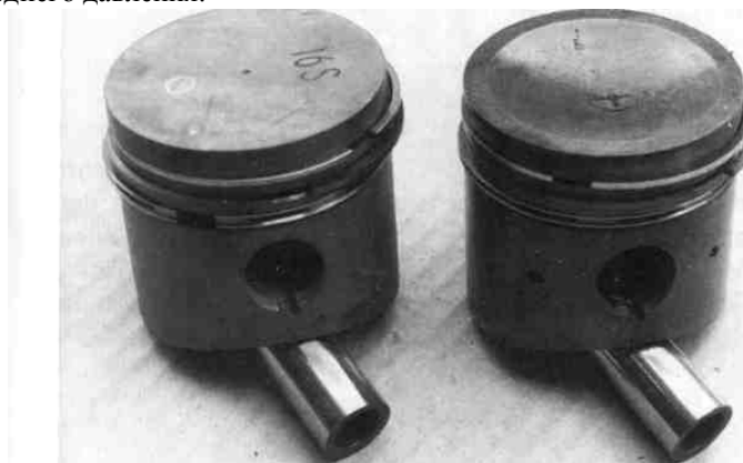
Можно изменить степень сжатия, установив поршни с другой формой днища.
