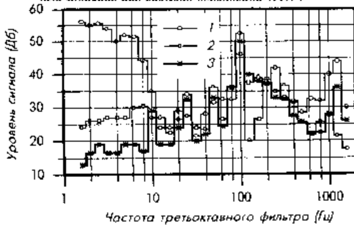
Рис. 3.8.2 Спектральная плотность колебаний абсолютного давления во впускной системе при открытии дроссельной заслонки (кривая 1), при закрытой дроссельной заслонке (кривая 2) и при открытой дроссельной заслонке (кривая 3) ( n=1000 мин -1 , время открытия дроссельной заслонки 0.2 с, максимальные значения при времени усреднения 1/32с)
