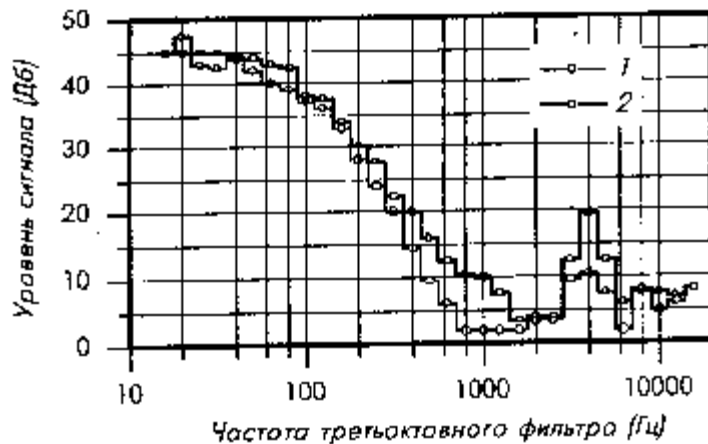
Рис. 5.3.2 Спектральная плотность колебаний давления газа в камере сгорания при работе двигателя без детонации (кривая 1) и при работе с детонацией (кривая 2). ( n=1000 мин -1 , Дроссель 100%, Время усреднения 1/32с)
