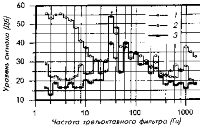
Рис. 3.8.2 Спектральная плотность колебаний абсолютного давления во впускной системе при открытии дроссельной заслонки (кривая 1), при закрытой дроссельной заслонке (кривая 2) и при открытой дроссельной заслонке (кривая 3) ( n=1000 мин -1 , время открытия дроссельной заслонки 0.2 с, максимальные значения при времени усреднения 1/32с)
