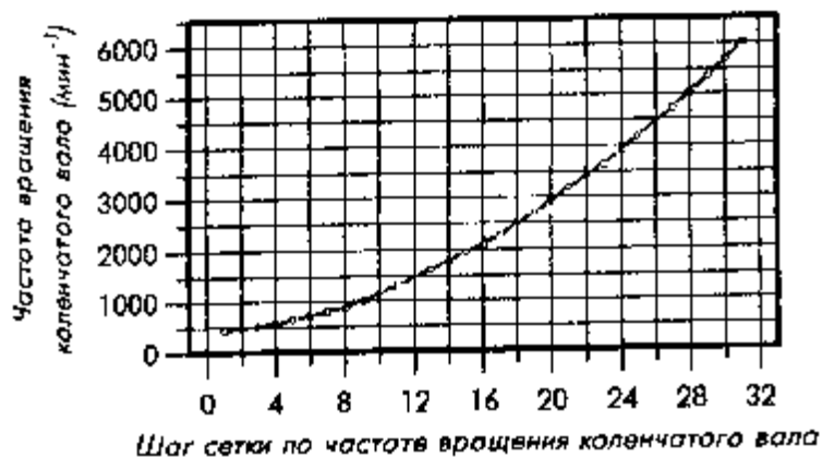
Рис. 8.2.7 Тарифовочная зависимость частоты вращения коленчатого вала от положения в сетке таблицы.
