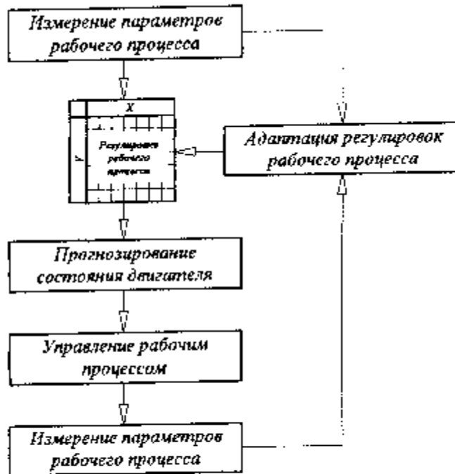
Рис. 8.3.2 Адаптация регулировок рабочего процесса по результатам непосредственного измерения параметров управления.
