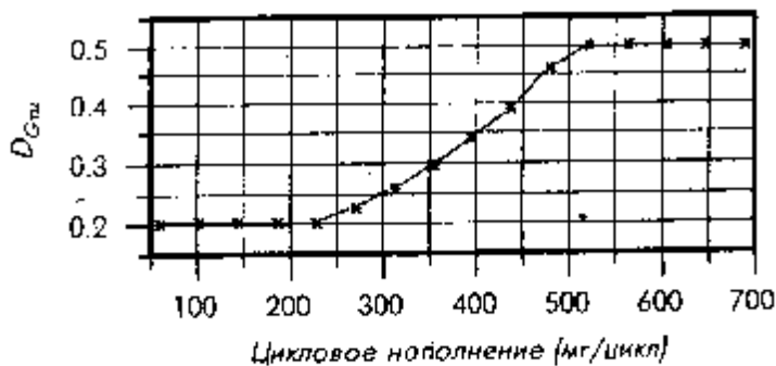
Рис. 4.4.5 Зависимость коэффициента динамической коррекции D_{D_{дин}} от циклового наполнения.
