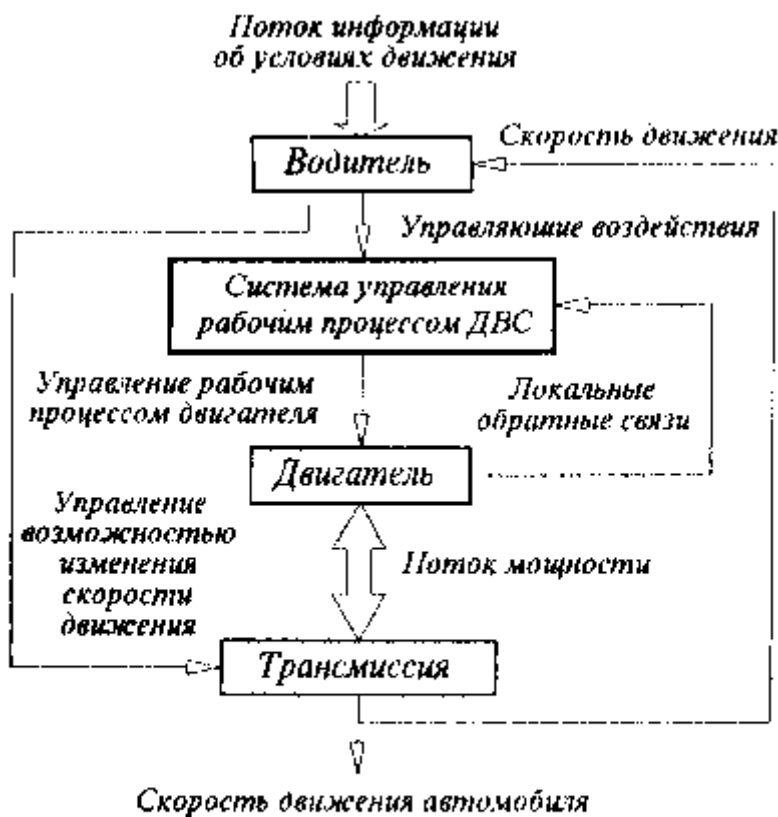
Рис. 1.2.1 Структура управления скоростью движения автомобиля
