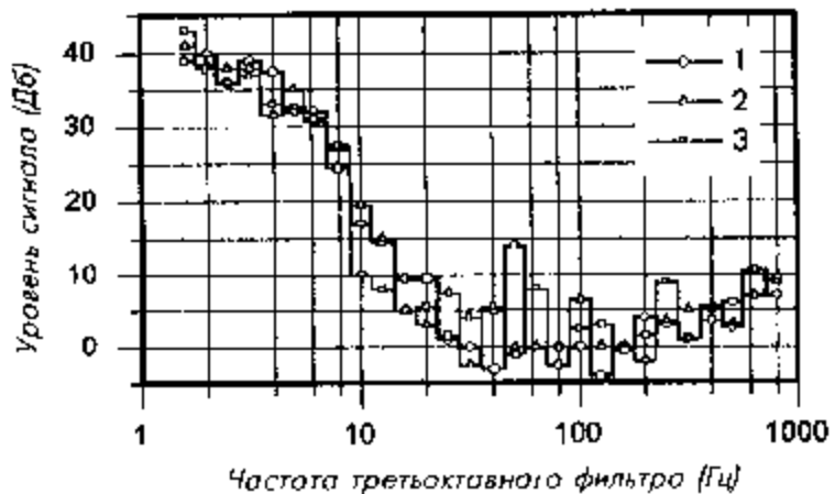
Рис. 1.6.2 Разность между максимальными значениями спектральной плотности колебаний сигнала датчика абсолютного давления во впускной системе при открытой дроссельной заслонке и при ее открытии за время равное 100 мсек. при n=1000\text{мин}^{-1} (кривая 1), n=2000\text{мин}^{-1} (кривая 2), n=3000\text{мин}^{-1} (кривая 3).
