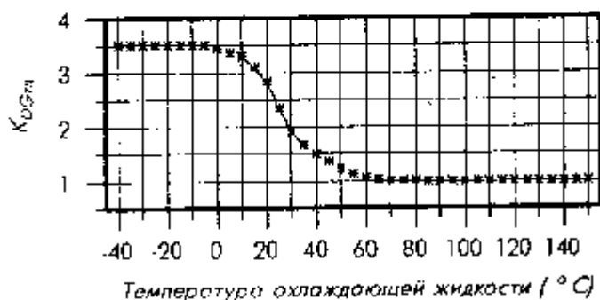
Рис. 4.4.6 Зависимость температурной поправки коэффициента динамической коррекции K_{D_{дин}} от температуры охлаждающей жидкости.
