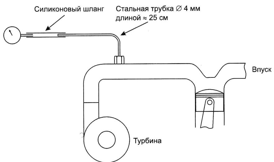
Рис. 14-6. Измерение давления на входе в турбину. Стальная трубка понизит температуру отработанных газов до приемлемого для силиконового патрубка уровня.
