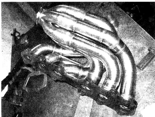
Рис. 10-6. Хороший образец сварного трубчатого коллектора для двигателя Toyota 2JZ-GTE.
