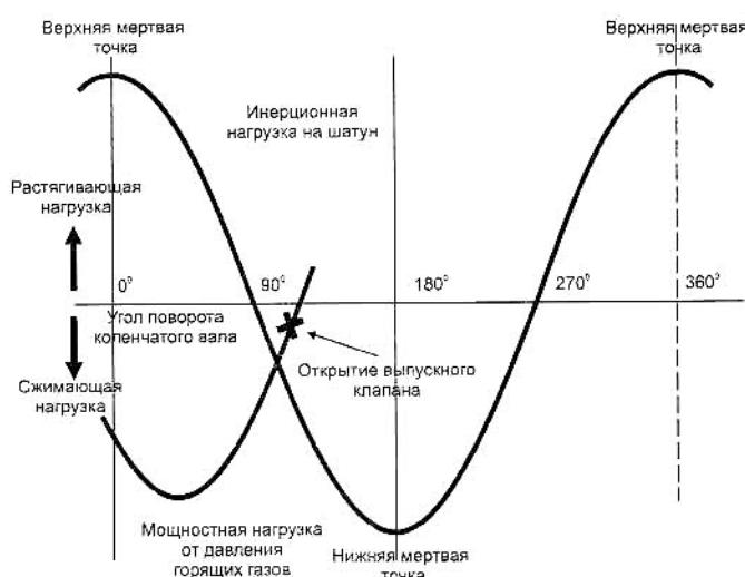
Рис. 1-5. Объединенный график мощностной и инерционной нагрузок. Заметьте, что мощностная и инерционная нагрузка вычитаются друг из друга.
