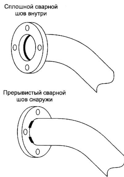
Рис. 11-5. Стыки фланца приемной трубы не должны быть сварены непрерывным швом на внешней стороне трубы.
