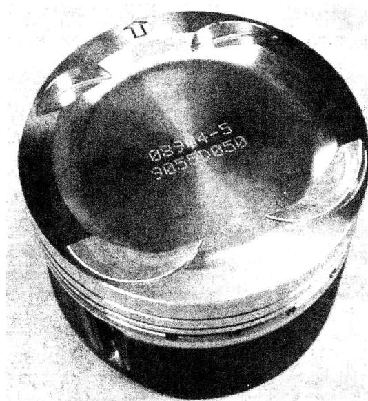
Рис. 13-10. Хороший поршень для турбонаддува будет иметь толстые, прочные площадки для колец. Кованый поршень для двигателя Toyota 3S-GTE
