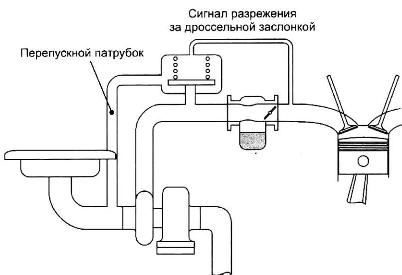
Рис., 8-10. Байпасный или противопомпажный клапан необходим в системах с продавливанием воздуха, чтобы быстро снизить давление в поплавковой камере при закрытии дроссельной заслонки.
