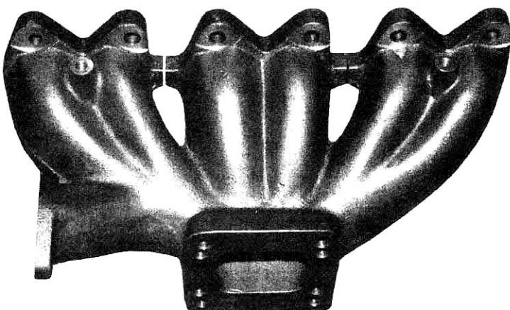
Рис. 10-7. Другой пример литого коллектора для VW Golf GTI VR6. Обратите внимание на разрезы на фланце для уменьшения влияния термических деформаций. Неудачное расположение фланца для вестгейта обусловлено требованиями компоновки турbonагнетателя под капотом переднеприводного автомобиля.
