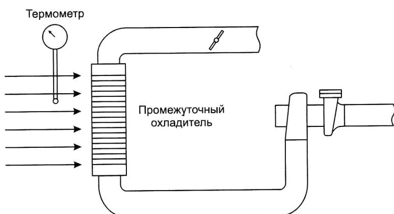
Рис. 14-3. Измерение температуры окружающей среды, необходимое для определения эффективности промежуточного охладителя.
