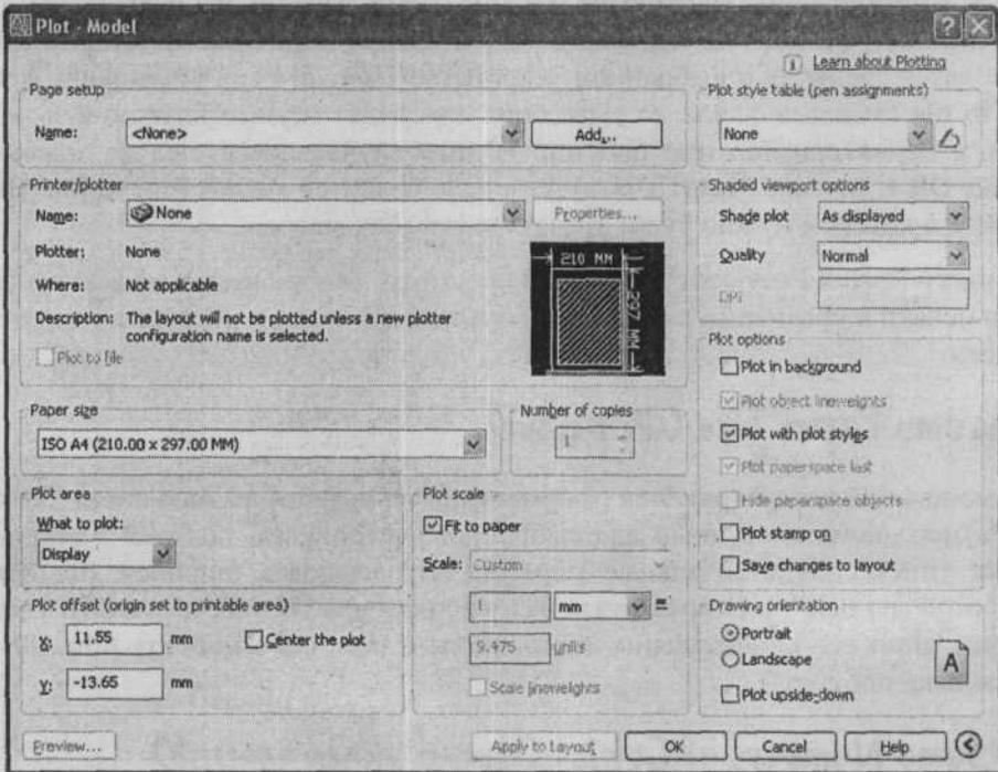
Рис. 7.45. Расширенный диалог **Plot** (Печать) с дополнительными параметрами
