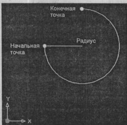
Рис. 3.29. Большая дуга, нарисованная при помощи варианта **Start, End, Radius** (Начало, конец, радиус) (S, E, R)
