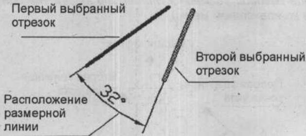
Рис. 6.28. Задание углового размера для отрезка
