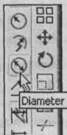
Рис. 6.24. Вызов команды **Diameter** (Диаметр) на панели инструментов **Dimension** (Размеры)
