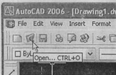
Рис. 1.35. Вызов команды **OPEN** на панели инструментов **Standard** (Стандартная)
