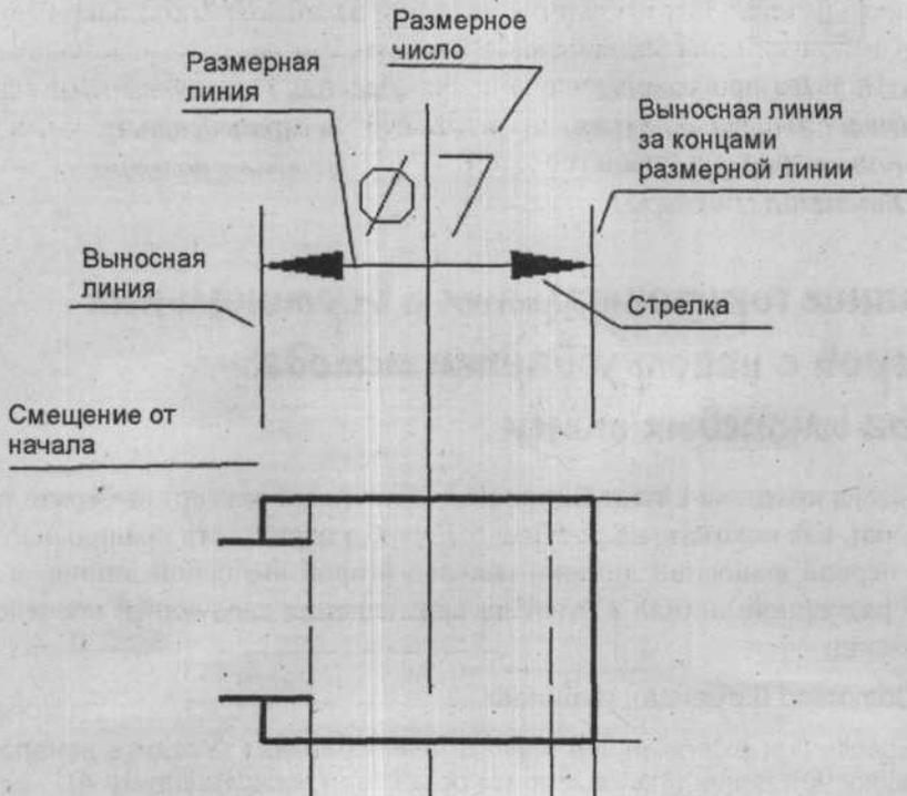
Рис. 6.4. Компоненты типичных размеров
