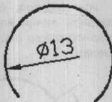
Рис. 6.25. Задание диаметра окружности
