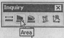
Рис. 6.30. Вызов команды **Area** (Площадь) на панели инструментов **Inquiry** (Сведения)
