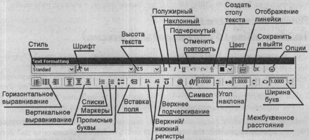
Рис. 5.7. Панель инструментов **Text Formatting** (Форматирование текста), линейка и ограничивающий прямоугольник для ввода/редактирования многострочного текста
