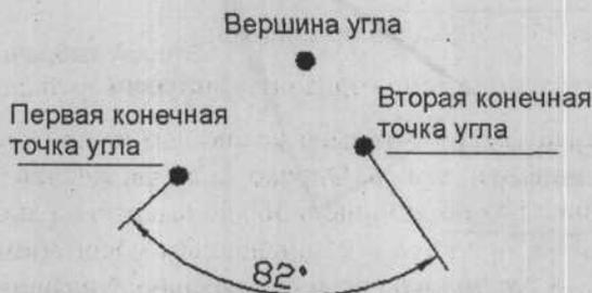
Рис. 6.29. Задание углового размера с использованием трех точек
