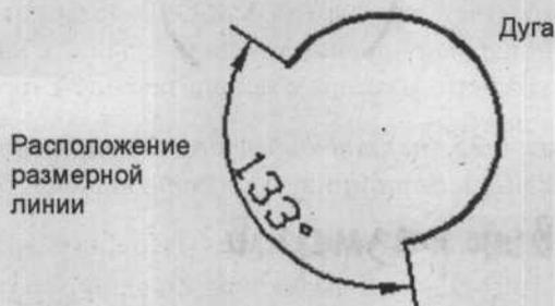
Рис. 6.27. Задание углового размера для дуги
