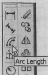
Рис. 6.14. Вызов команды **Arc Length** (Длина дуги) на панели инструментов **Dimension** (Размеры)
