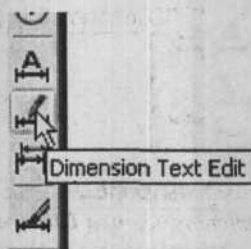
Рис. 8.40. Вызов команды DIMTEDIT (Редактировать текст) из панели инструментов Dimension (Размеры)
