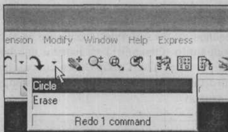
Рис. 3.38. Отображение списка команды REDO (Повторить) на панели инструментов Standard (Стандартная)
