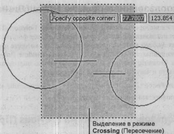
Рис. 4.2. Выбор объектов с использованием режима Crossing (Пересечение)
