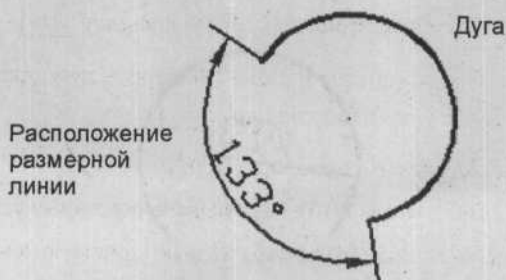
Рис. 6.27. Задание углового размера для дуги
