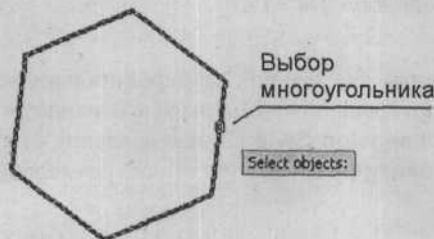
Рис. 6.31. Нахождение площади многоугольника с использованием параметра Object (Объект) команды AREA
