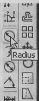
Рис. 6.20. Вызов команды Radius (Радиус) на панели инструментов Dimension (Размеры)
