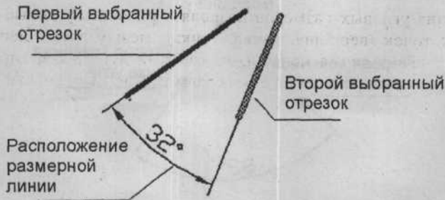
Рис. 6.28. Задание углового размера для отрезка
