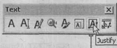
Рис. 5.18. Вызов команды JUSTIFYTEXT (Выравнивание текста) на панели инструментов Text (Текст)
