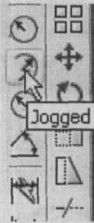
Рис. 6.22. Вызов команды Jogged (зигзагообразный) на панели инструментов Dimension (Размеры)
