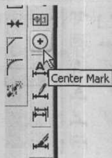
Рис. 8.36. Вызов команды DIMCENTER (Маркер центра) из панели инструментов Dimension (Размеры)
