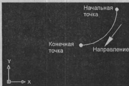
Рис. 3.33. Дуга, нарисованная в направлении по часовой стрелке с начальной (3,2) и конечной (2,1) точкой
