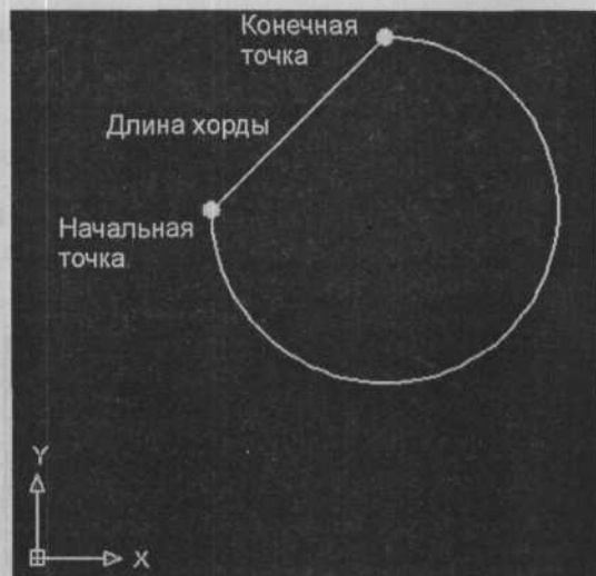
Рис. 3.28. Большая дуга, нарисованная с использованием варианта Start, Center, Length of Chord (Начало, центр, длина хорды) (S, C, L)
