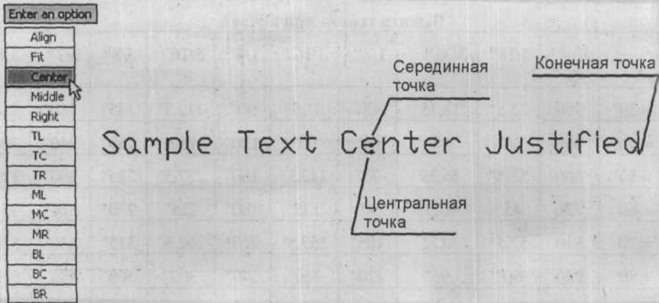
Рис. 5.4. Использование команды DTEXT для размещения текста с указанием центральной точки (выравнивание по центру), серединной точки (выравнивание по середине) или конечной точки (выравнивание по правой стороне)
