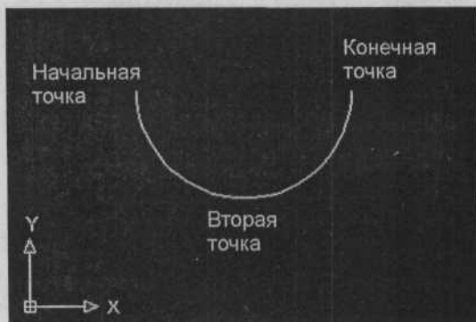
Рис. 3.21. Дуга, нарисованная с использованием варианта по умолчанию команды ARC : варианта Three Points (Три точки)
