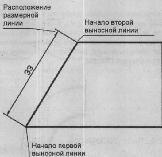
Рис. 6.13. Рисование параллельного размера для отрезка, нарисованного под углом
