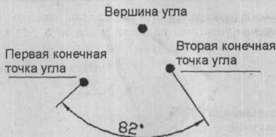
Рис. 6.29. Задание углового размера с использованием трех точек
