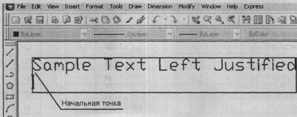
Рис. 5.3. Использование команды DTEXT для размещения текста, выровненного по левой стороне, в указанной начальной точке
