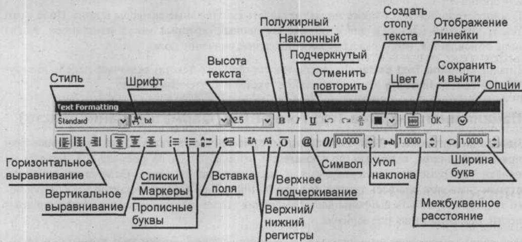
Рис. 5.7. Панель инструментов Text Formatting (Форматирование текста), линейка и ограничивающий прямоугольник для ввода/редактирования многострочного текста
