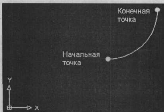
Рис. 3.31. Дуга, нарисованная по начальной точке (2,1), конечной точке (3,2) и радиусу, равному 1,0
