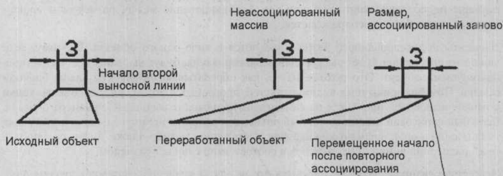
Рис. 6.11. Неассоциированный размер, который был заново ассоциирован
