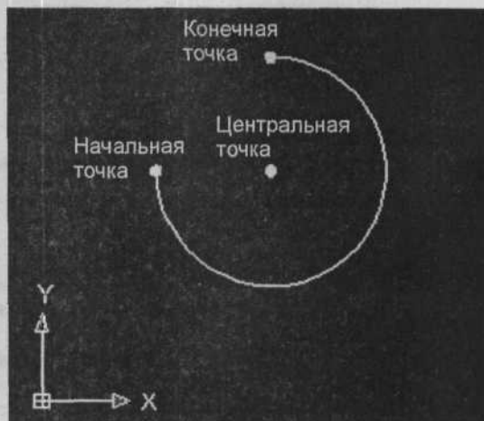
Рис. 3.22. Дуга, нарисованная с использованием варианта Start, Center, End (Начало, центр, конец) (S, C, E)
