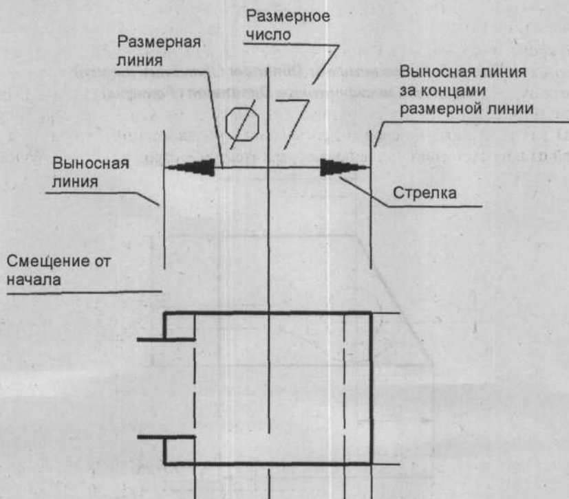
Рис. 6.4. Компоненты типичных размеров
