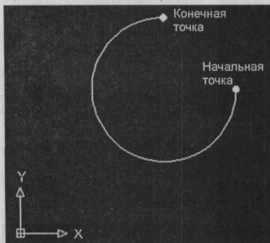
Рис. 3.25. Дуга, нарисованная в направлении против часовой стрелки с использованием варианта Start, End, Angle (Начало, конец, угол)
