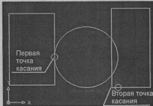
Рис. 3.19. Окружность, нарисованная при помощи метода Tangent, Tangent, Radius (Касательная, Касательная, Радиус)
