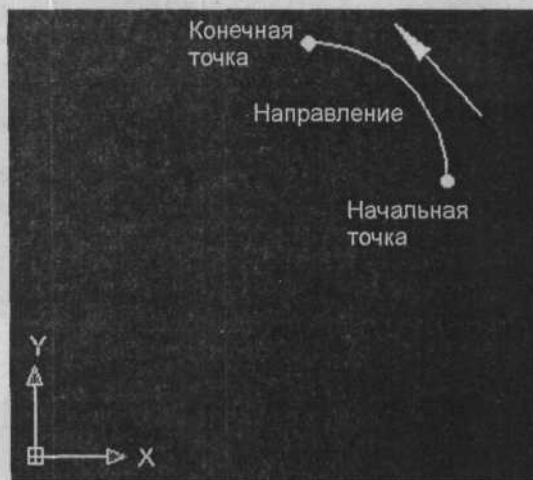
Рис. 3.26. Дуга, нарисованная с использованием варианта Start, End, Direction (Начало, конец, направление) (S, E, D)
