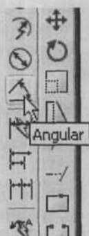
Рис. 6.26. Вызов команды Angular Dimension (Угловой размер)
