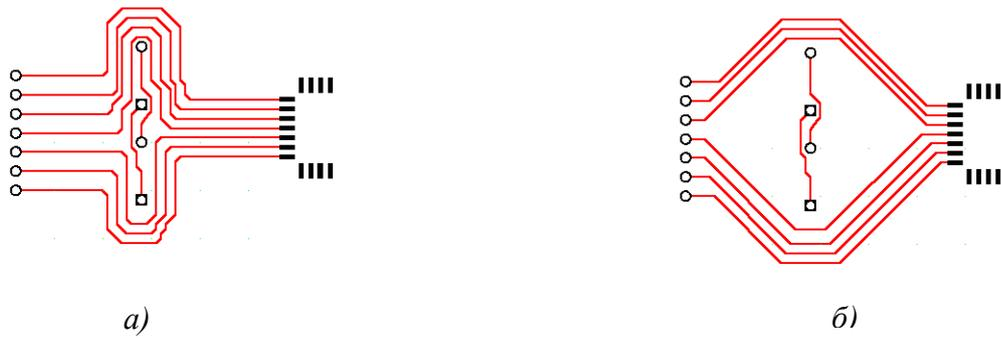
Рис. 9-39. Режимы прокладки проводников с максимальным прижатием а) и с минимальной длиной б)
