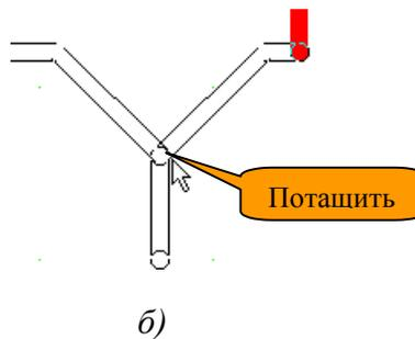
Рис. 9-35. Сглаживание Т-образных соединений проводников командой **Route/Miter**
