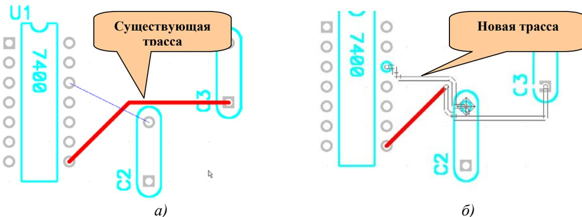
Рис. 9-33. Действие режима расталкивания трасс (Push Traces)
