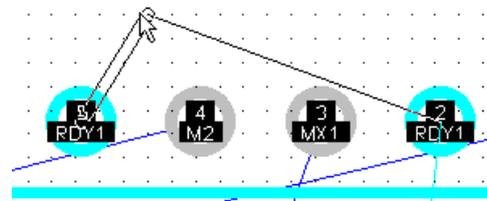
Рис. 9-27. Вид текущего сегмента проводника при нажатой левой кнопке мыши
