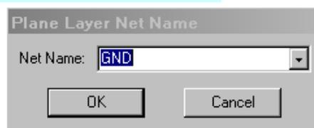
Рис. 9-42. Указание имени цепи, подключаемой к слою металлизации.
