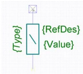
Последним обязательным элементом является точка привязки, за которую элемент будет перетаскиваться на схеме и которая всегда попадает в узел сетки. Размещается она, как правило, в одном из выводов.
