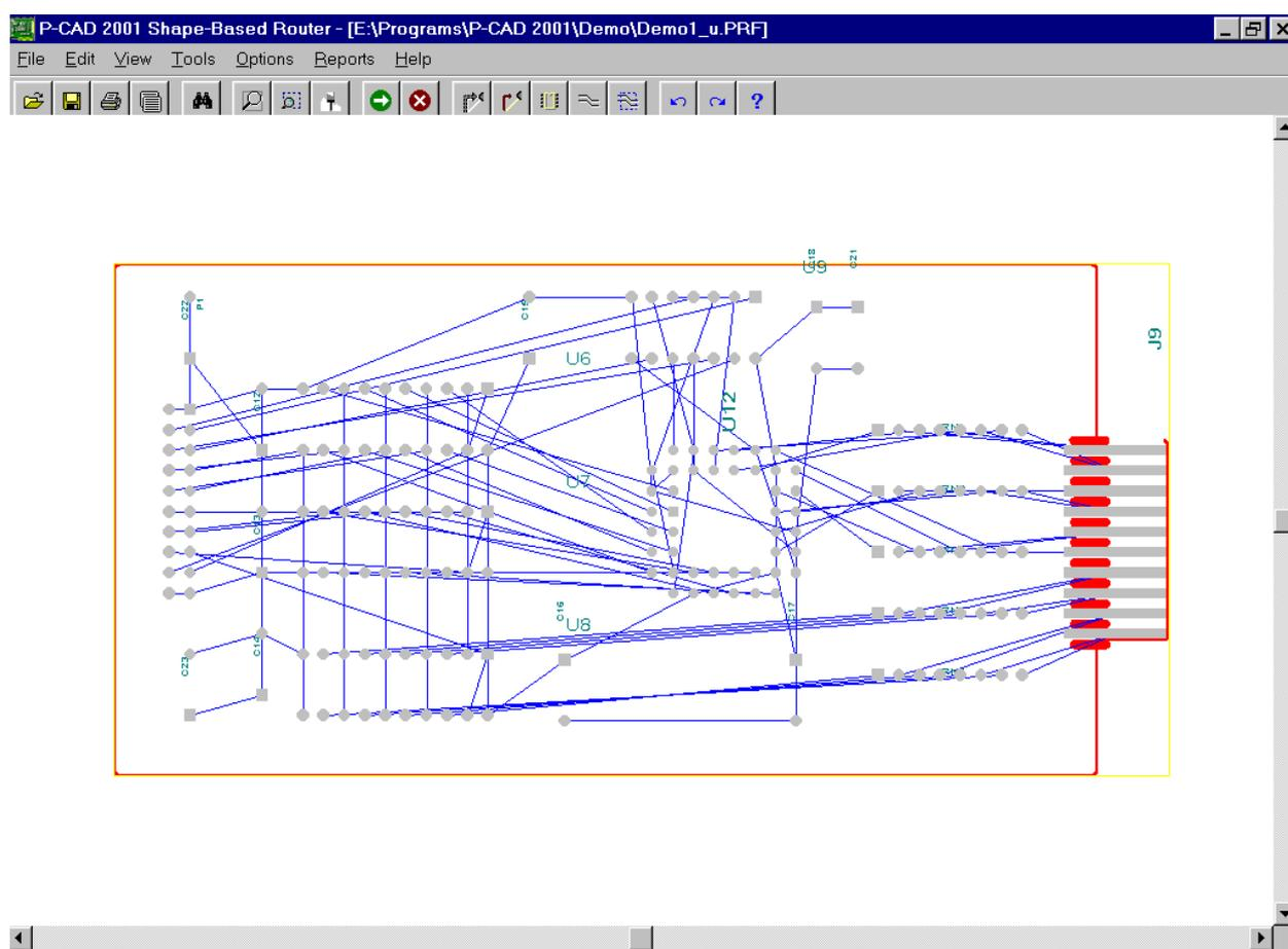
Рис. 10-16. Рабочее окно автотрассировщика **Shape-Based Router**
