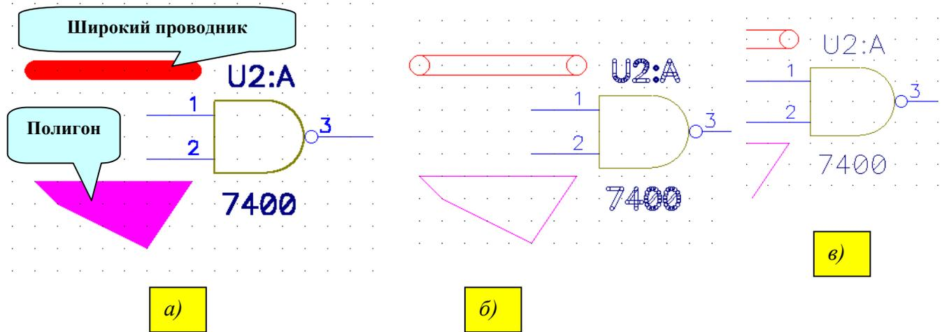
Рис. 3-12. Режимы отображения проводников, полигонов и текстов:
