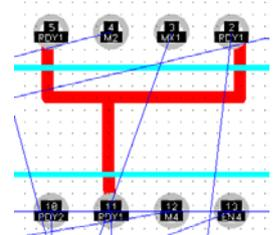
Рис. 9-30. T-образная трассировка
