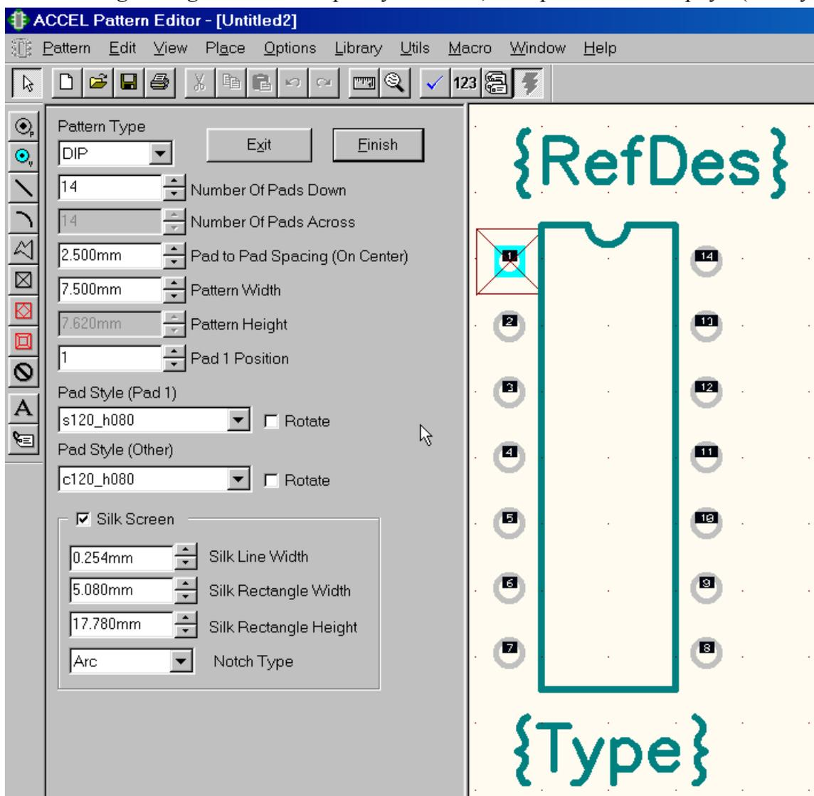
Рис. 8-22. Создание корпуса с помощью мастера
