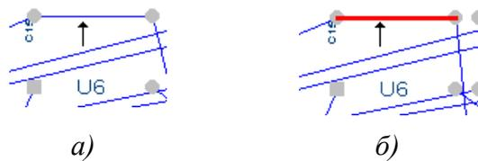
Рис. 10-25. Интерактивная трассировка отдельных соединений
