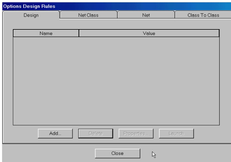
Рис. 6-26 Панель установки правил конструирования ПП
