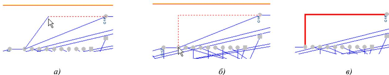
Рис. 10-27. Ручная трассировка проводников
