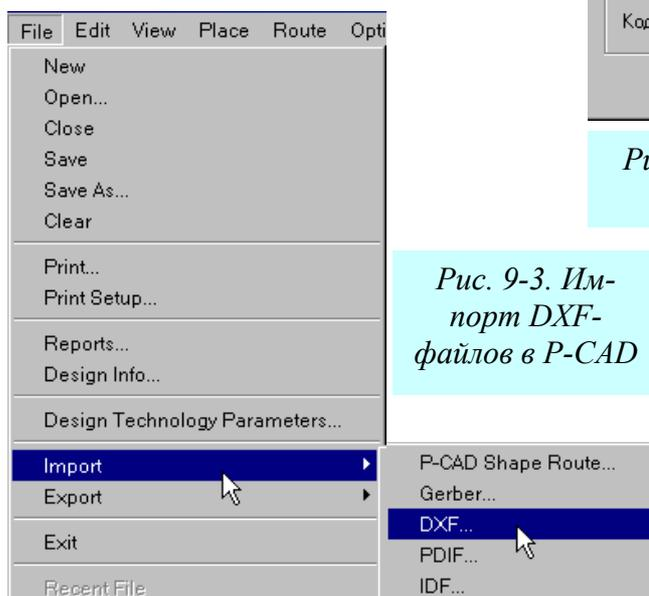
*Рис. 9-3. Импорт DXF-файлов в P-CAD*
