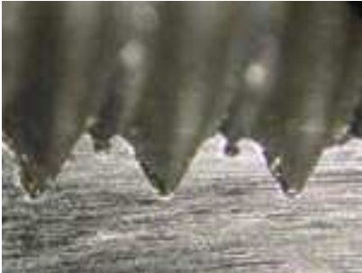
Сечение резьбы, полученное бесстружечным метчиком (раскатником), в стали 45
