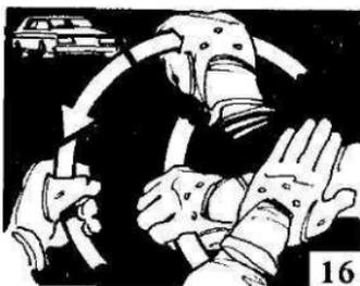
Завершив крутой поворот или разворот автомобиля, выравнивайте его одной либо двумя руками активными тормозящими действиями, исключая проскальзывание РК или его самовыравнивание. Такие действия повысят безопасность в заключительной фазе маневра и помогут экстренно среагировать на возможный занос.
