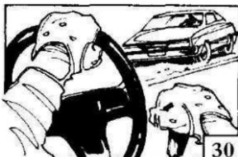
Если вы попали в критическую ситуацию на повороте и во время стабилизации автомобиля двигатель потерял мощность, то переходите к рулению левой рукой. Правой рукой попытайтесь включить понижающую передачу, не дожидаясь, пока автомобиль попадет на обочину.
