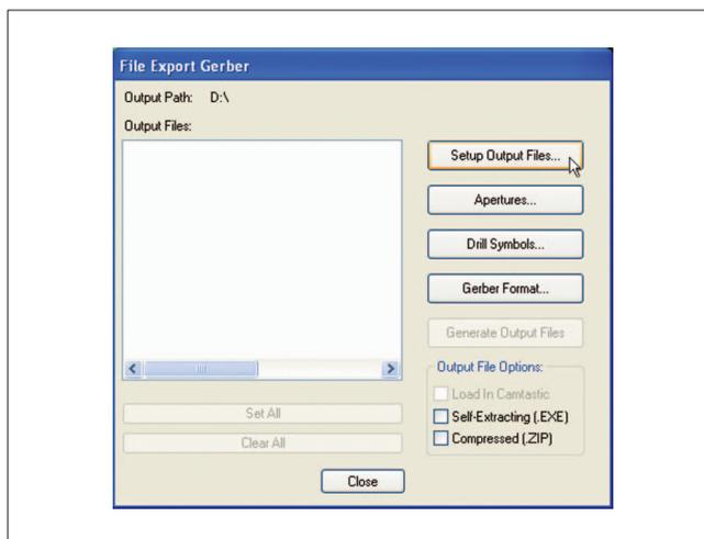
Рис.2. Окно экспорта Gerber-файлов. Переход к окну конфигурации Gerber-файлов
