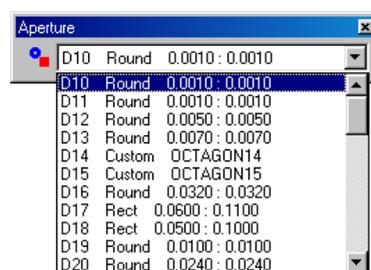
Рис. 7.29. Список используемых в проекте D-кодов.
