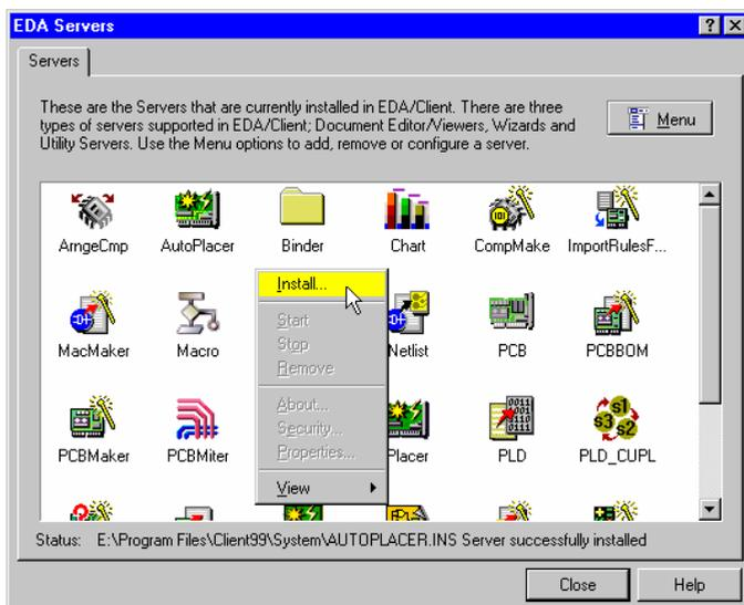
Рис. 2.32. Инсталляция сервера в среду проектирования Design Explorer.
