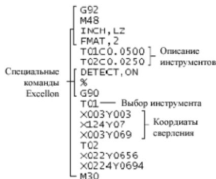
Рис. 7.11. Структура формата файлов NC Drill.
