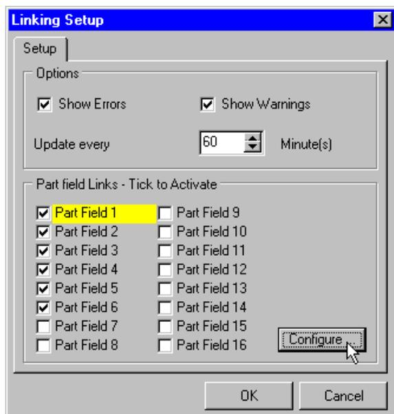
Рис. 3.47. Настройка горячей связи с внешней базой данных.
