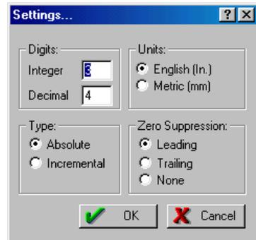
Рис. 7.10. Настройка функций импорта Gerber файлов.
