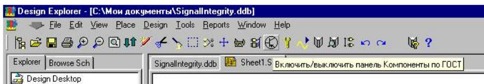
Рис. 2.34. Кнопка включения панели инструментов "Компоненты по ГОСТ".
