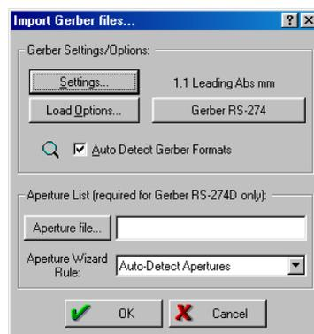
Рис. 7.18. Стандартная загрузка Gerber файлов.
