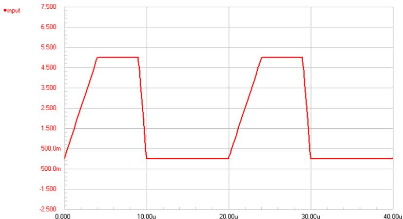
Рис. 4.33. Пример периодической последовательности импульсов
