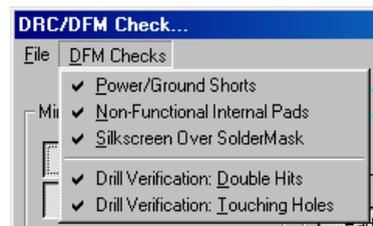
Рис. 7.41. Опции проверки DFM.
